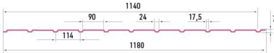
Querschnitt Profil T7 – Deckbreite 1140 mm, Profilhöhe ca. 7 mm
